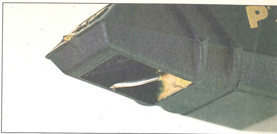
Al termine del cantilever in alluminio è incastrata una piccolissima puntina con taglio «multi-faccia».
